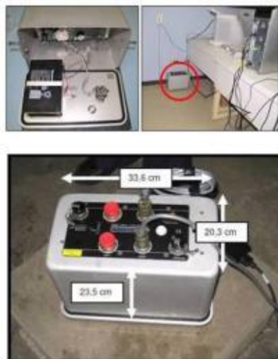
Acelerógrafo digital de 24 bits
