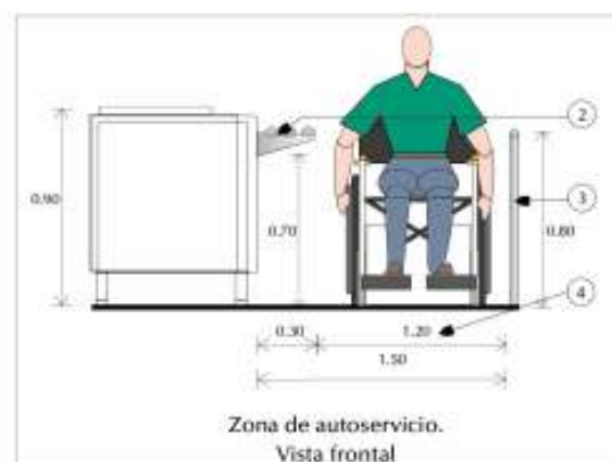
Dimensiones para las áreas del comedor en silla de ruedas. Planta arquitectónica.
