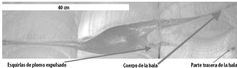
**Figura 2-12.** Fragmentación de la bala encamisada durante la fase 2, “eje cavitación temporal”.
