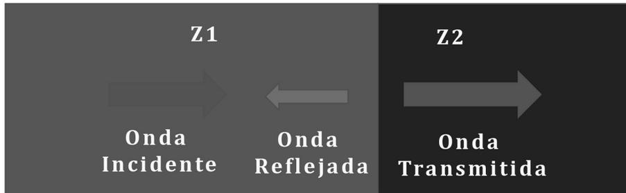
**Figura 1–8.** Reflexión y refracción de una onda acústica con incidencia normal entre dos medios con diferente impedancia acústica.
