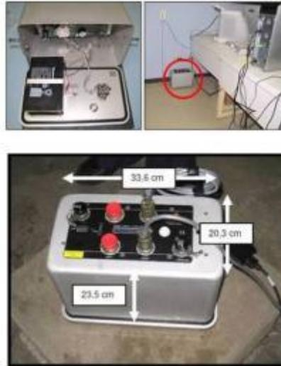
Acelerógrafo digital de 24 bits
