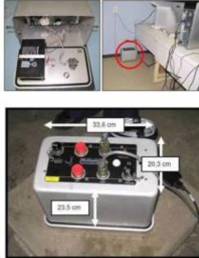
Acelerógrafo digital de 24 bits
